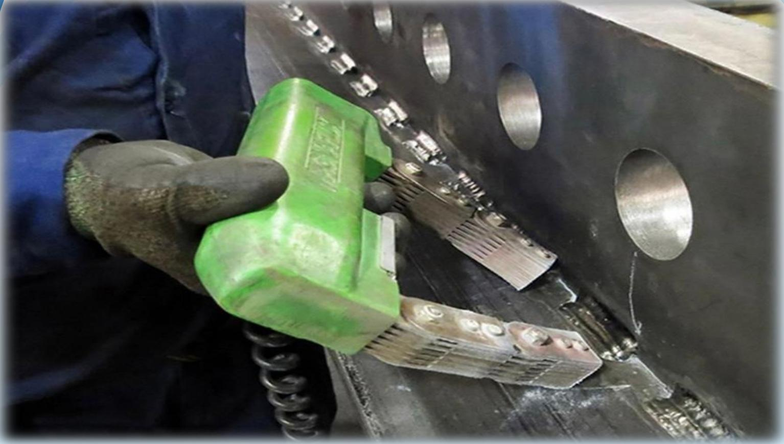
Manyetik parçacık yöntemi yüzey ve yüzeye yakın hataların tespitinde ve yerlerinin belirlenmesi işleminde kullanılan oldukça basit, hızlı ve düşük maliyetle uygulanabilirliğinden dolayı ferromanyetik malzemelere uygulanan oldukça geniş bir kullanıma sahiptir. Bu yöntemde yüzey hatalarının belirlenebilmesi hatanın boyutuna ve yüzeye yakınlığına bağlı olup sadece ferromanyetik yani mıknatıslanabilen malzemelere uygulanır
